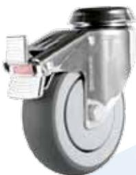
Rodachinas giratorias altamente resistentes; ensambladas en un tenedor giratorio fabricado en acero **Inoxidable** y rueda en caucho termoplástico. Silenciosa, amortiguada, que no marca los pisos, con balineras de precisión con o sin freno total. **Ideal para trabajar en ambientes corrosivos.**
